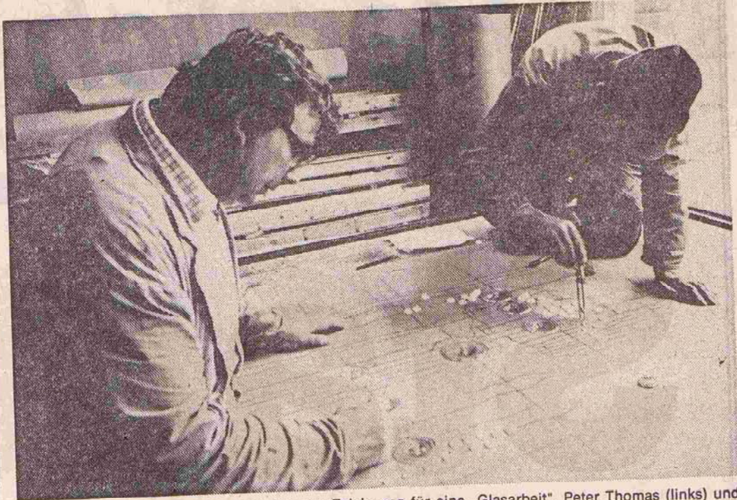
Viel Zeit und Arbeit kostet das Erstellen der Zeichnung für eine „Glasarbeit“. Peter Thomas (links) und einer seiner Mitarbeiter legen die unterschiedlichen Glasstücke auf den Karton und zeichnen die Umriss ab.
